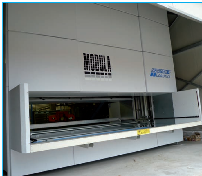
Gestione acciai con magazzino automatico verticale Automatic load system for steels' storage
